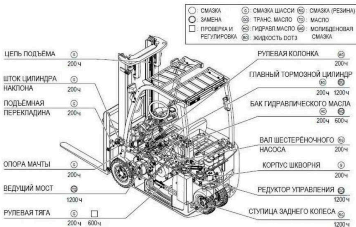
Иллюстрация 5. Места смазки Погрузчика с указанием рекомендованных работ и моточасов.
